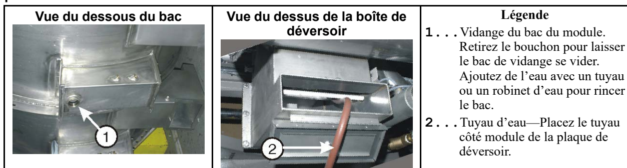
Figure 30. Vidange du bac du module et boîte de déversoir. Il s'agit d'exemples. Votre machine peut être différente.
