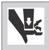
**Quetschgefahr** — Durch den Kontakt mit der drehenden Trommel können Ihre Gliedmaßen gebrochen werden. Jeder Versuch, die Trommel mit irgendeinem Gegenstand zu stoppen, kann dazu führen, dass sie von diesem getroffen oder durchbohrt werden. Die drehende Trommel ist normalerweise durch die verriegelte Trommeltür unzugänglich.
