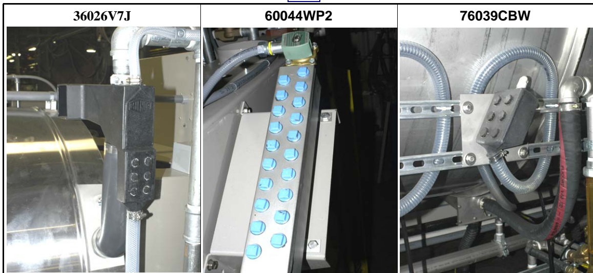
图 8: 皂液泵系统的皂液歧管入口。参见警告说明 23 。以下为示例。您的机器可能与此不同。
