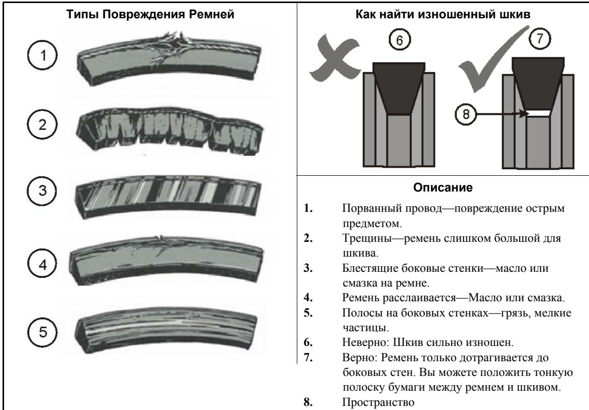
Картинка 6: Ремень и Шкив Поиск Состояния. Смотрите Дополнение 1 .
