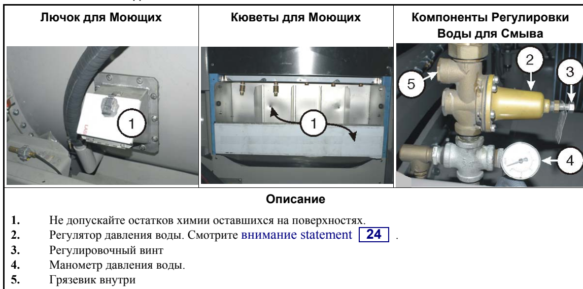
Картинка 9: Лючок для Моющих и Опция 5-отсеков для Сухой Химии. Это примеры. Ваша машина может выглядеть иначе.
