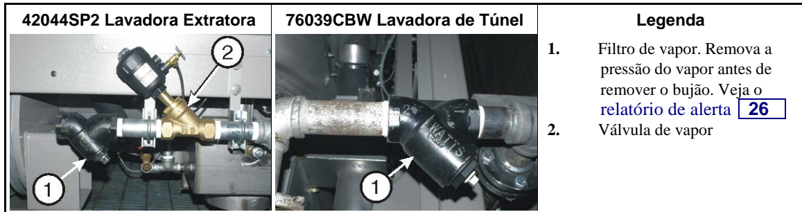
Imagem 12: Filtro de entrada de vapor. Estes são apenas exemplos. Sua máquina pode ter outra aparência.
