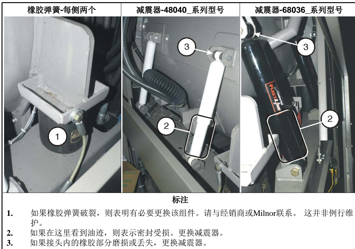
图 19: 橡胶弹簧悬挂洗衣脱水机两侧的悬挂组件 (参见附件 4)
