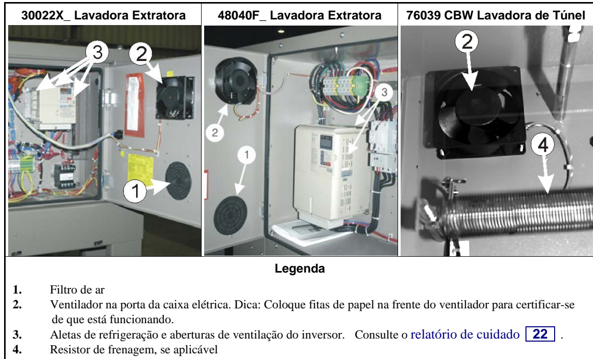
Imagem 7: Caixa elétrica e inversor. Estes são apenas exemplos. Sua máquina pode ter outra aparência.
