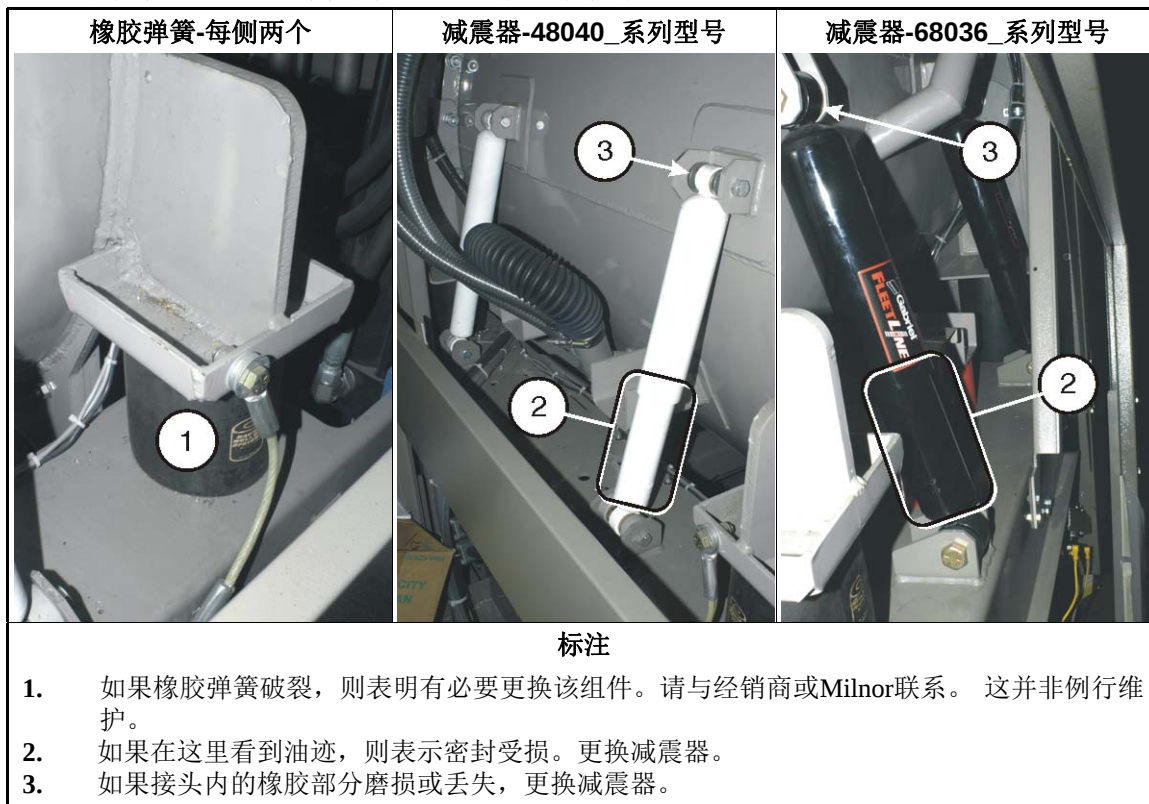
图 14: 橡胶弹簧悬挂洗衣脱水机两侧的悬挂组件 (参见附件 3)
