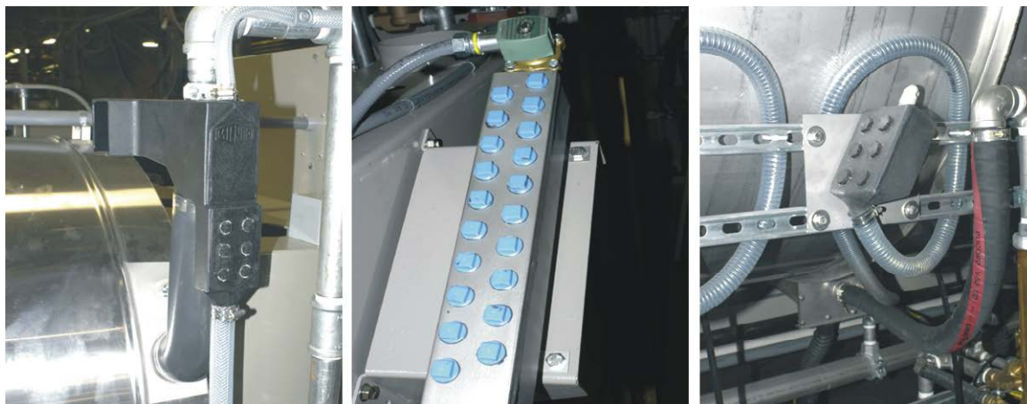
Illustration 4: Exemples de tubulures pour les tubes de produits chimiques. Votre équipement peut sembler différent.
