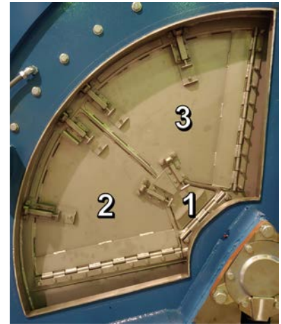
Figure 7. Portes intérieure et extérieure alignées
