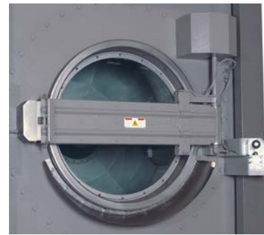
Figure 5. porte automatique à actionnement hydraulique
