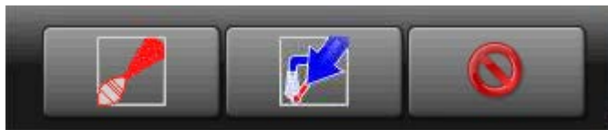
Figure 19. Commandes contextuelles pour les robinets de vapeur et de refroidissement
