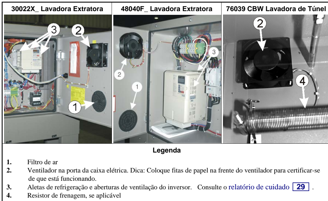
Imagem 12: Caixa elétrica e inversor. Estes são apenas exemplos. Sua máquina pode ter outra aparência.
