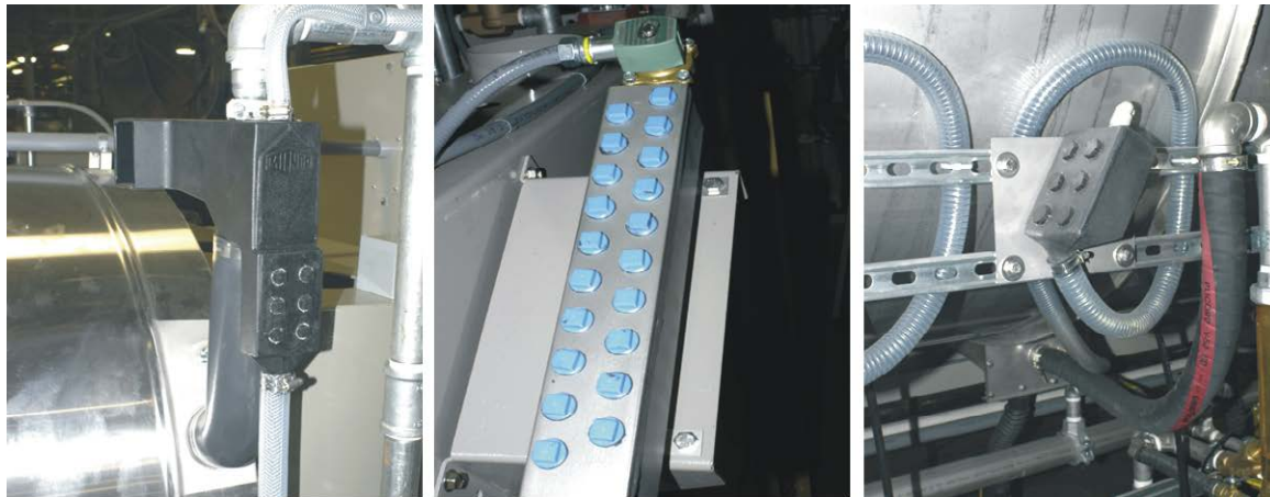
Imagem 8: Exemplos de tubos de distribuição de produtos químicos para tubos de produtos químicos. Seu equipamento pode ter outra aparência.
