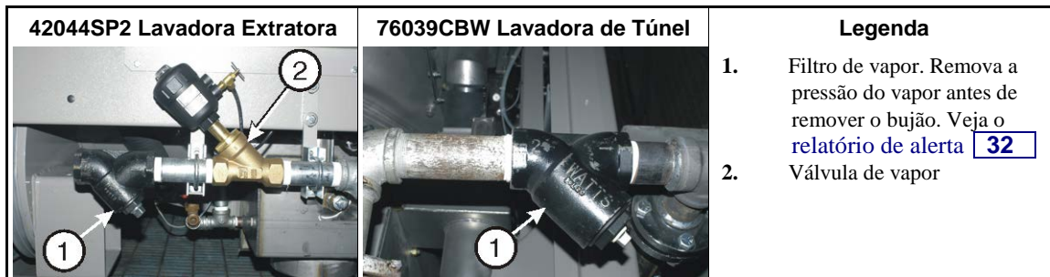
Imagem 16: Filtro de entrada de vapor. Estes são apenas exemplos. Sua máquina pode ter outra aparência.
