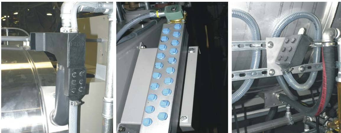
図 8: 洗剤チューブ用マニホールドの例。ご使用の機器はこれと異なる場合があります。
