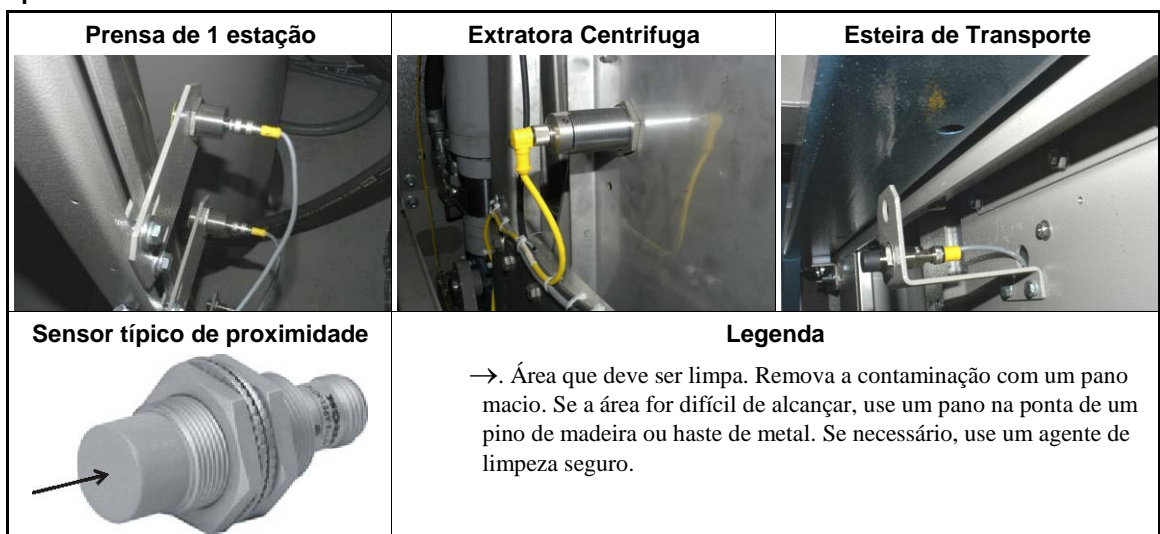
Imagem 20: Sensores de proximidade Estes são apenas exemplos. Sua máquina pode ter outra aparência.
